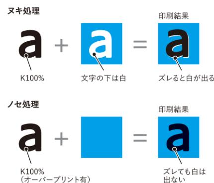
このような処理を印刷業界ではニゲ処理やかぶせ処理と言っているが、紙の印刷工程の場合は、前述したように総称してトラッピング処理で通じる。軟包装材料印刷の場合は伸び縮みが大きいので、ニゲ処理は必須だ。非印刷体の伸び縮みで透明フィルムの地が出てしまったりするので、紙材よりは多めの、太らせ量が必要だ(この場合こそ0.3mm)。また、フィルムは透明なので、紙のように印刷するには白地を印刷する必要がある。これを白座布団と呼んでいる。
