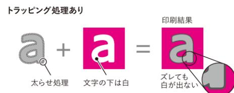
機械精度が良くても、印刷に使われる紙は、印圧や湿し水の影響で伸縮するので、抜き合わせだと白が出る可能性が高くなるのだ。この現象を防ぐために毛抜き合わせ(トラッピング)処理を行うことが一般的だ。毛抜き合わせは、A色もしくはB色(淡い色側を太らせるのが一般的)の絵柄をほんのわずか太らせ、重ね合わせることで紙の白が出るのを防ぐ方法だ。重なり合う部分の輪郭が目立たなく、また白が出ないように調整するのがポイントだ。英語ではスプレッド&チョーク(その逆も可)という。つまり「白地が出ないようにすることをニゲ処理というのだ」くらいに捉えればよく、難しいことは考えずに白や薄い色を濃い色に潜らせると考えれば良い。この処理のことを全体的にトラッピング処理と呼んでいるので、「何でもかんでもトラッピング」と言ってしまうとかわまない。
