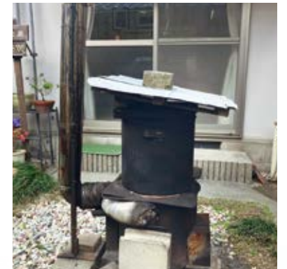
樹皮を剥ぎやすくするために原木を蒸す所
