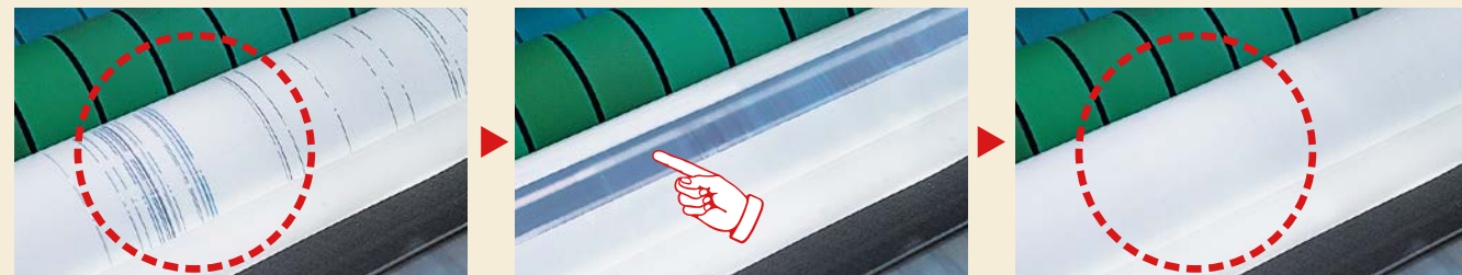
異物が混入するとインキツボローラーにムラが
