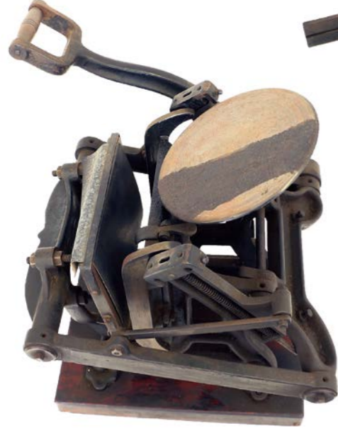
手フート印刷機 上部に見える円盤にインキを盛り、左側の版台に活版をセット。奥のハンドルを手動で上下させることにより、ローラーにインキを盛り、版ズラにインキを塗布、用紙を手差しで差し入れ手動で加圧して印刷していました。
