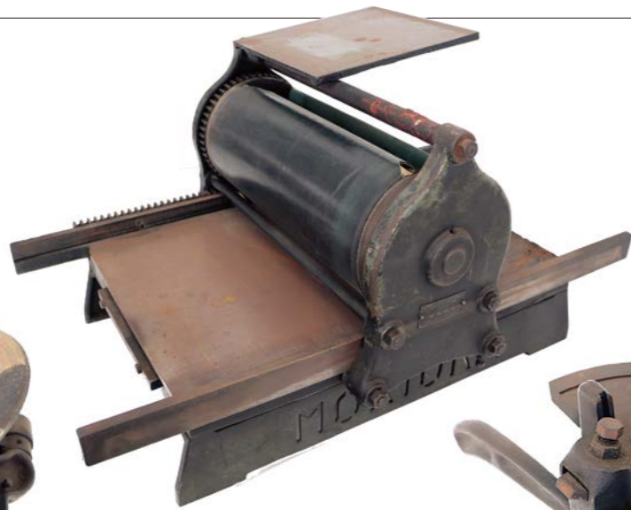
手動活版校正機 台座に活字で組版された版をセットし、インキローラーでインキを塗布。その上用紙を置いて、上部のローラーで加圧して、校正刷りをしていました。ローラ上部の板は、インキを盛り、ローラーにインキを塗布するための板です。
