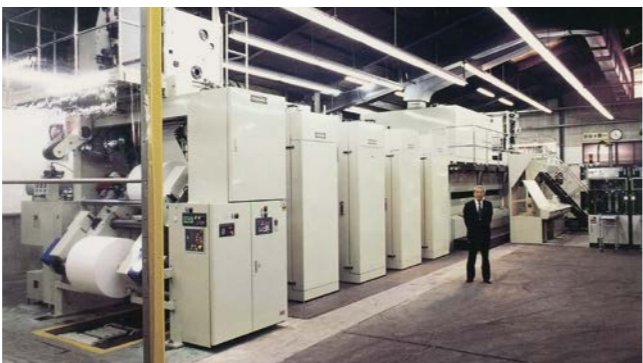
平成5年に導入したAタテ全判両面4色オフセット輪転機と井下現会長
