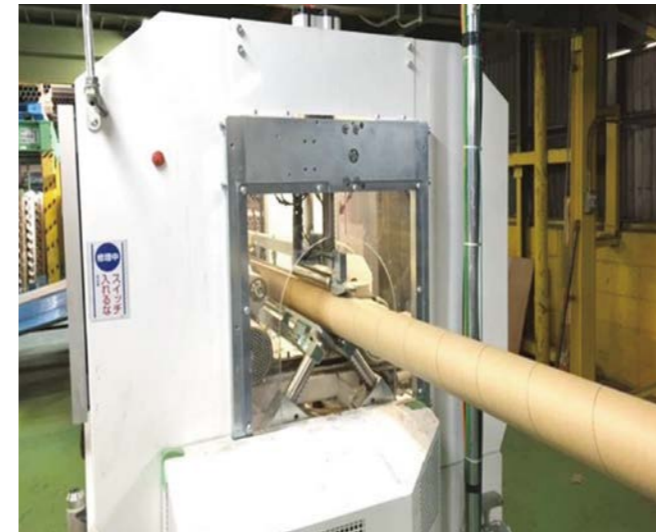
紙管スパイラルマシン
