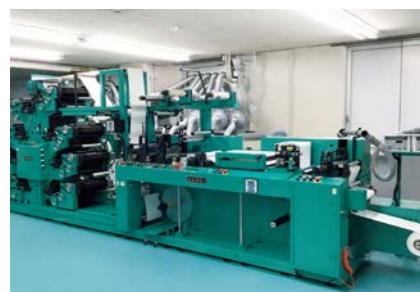
ロールラベル印刷機(大ロットのラベルを高品質で提供) 樹脂凸版 紙グラーラベル/最大色数:片面8色or表5色+裏3色、印刷サイズ:330mm幅×158.75~476.25mm
