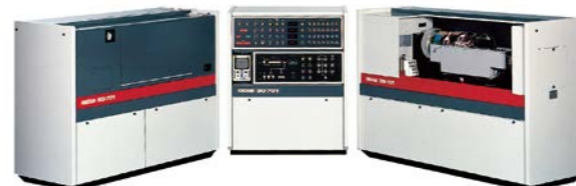
写真1 SG-701という4色同時分解できる生産性の高いカラスキャナー
