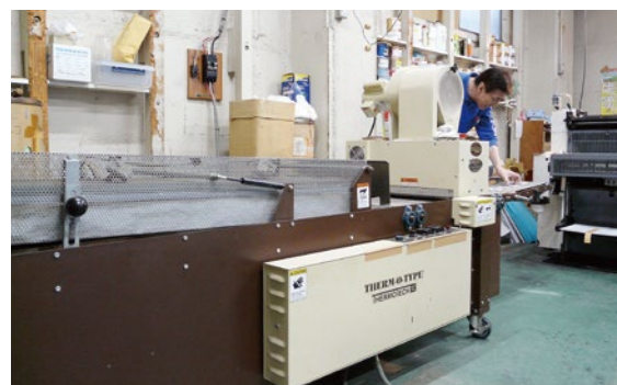
最大紙サイズA4、1時間に名刺1,200枚が可能な盛上げ印刷機
