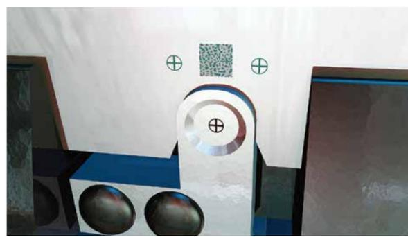
各印刷ユニット前に取り付けられたカメラで刷版セット位置を検知して印刷前に見当を調整するだけでなく、この刷版に同時にQRコードを含めることで、自動で刷版データを認識して必要な情報を取り込むので、リピート印刷時はフィーダーからデリバリーまで自動で行えます。
